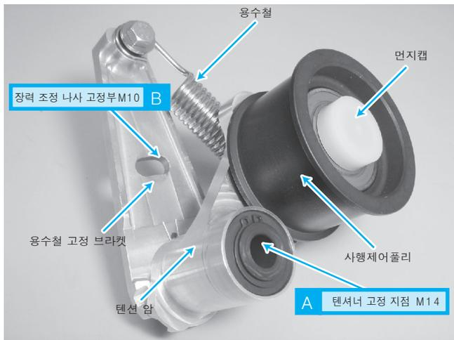
자동차 분야에서 오랫동안 축적해온 고무, 심선 설계 기술을 구사하여 고전동, 고효율의 평벨트 사양으로 되어 있습니다. 평벨트의 사행을 제어하는 폴리를 장착함으로써 벨트와 폴리로 자율제어를 할 수 있게 되어 장력부여를 용수철로 안정유지를 함으로서 장수명, 메인テナンス 프리화가 가능해 졌습니다. 장착은 A와 B의 부분을 브라켓 (장착판)에 설계 처럼 고정함으로써 용이하게 장착할 수 있고 그리고 적정 장력이 될 수 있게끔 설계되어 있습니다.
